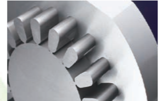
モータコア金型での高精度加工
