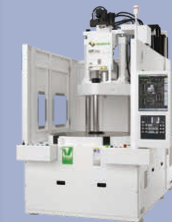
VR Gシリーズ「VR75G」ハイブリッド縦型ロータリ射出成形機の新製品。さらなる制御能力向上とハイサイクル化により電力消費量22%削減を実現
